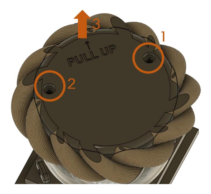
4. 2内部の電池が見えるので押しながら上に抜く。
